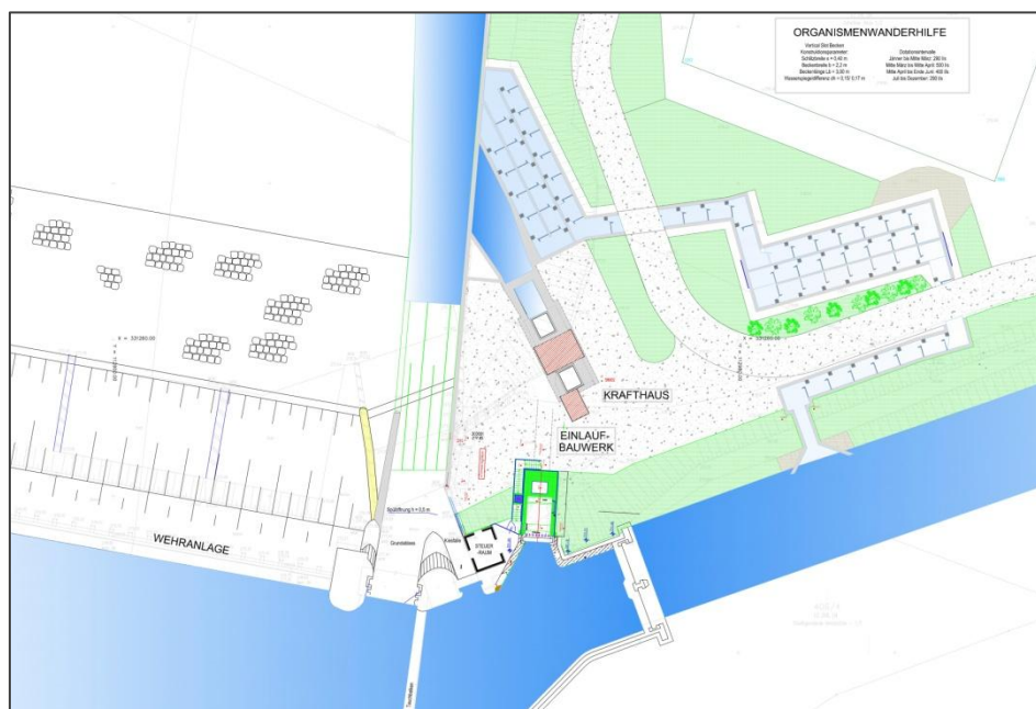
Bild: Plan Fischaufstieghilfe und Restwasserturbine (hochaufgelöstes Foto hier )
